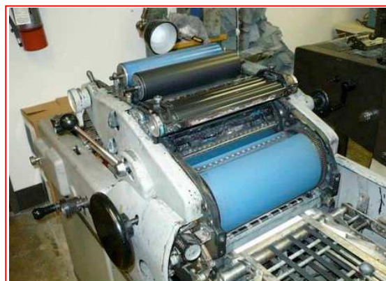
Multilith 1200, detail op rubberdoekcylinder (blauw), direkt daarachter half zichtbaar de plaatcylinder met een reeks pennen waar de plaat mee ingeklemd wordt, erboven de inktrollen. Geheel rechtsonder is een deel van de papierbaan zichtbaar: een snelle baan die vel voor vel het papier naar de rubberdoekcylinder schiet.
