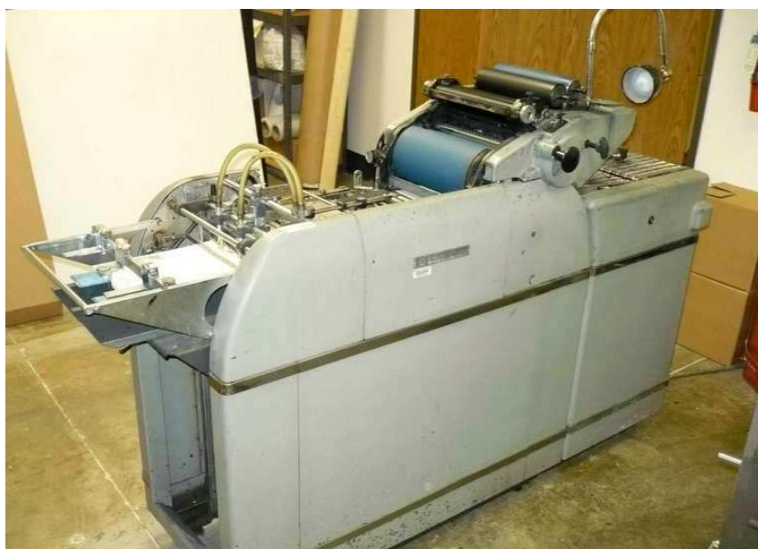
AM Multilith 1200, gezicht op achterkant, links op foto papierinvoer (pneumatisch) rechts kettinguitleg.
