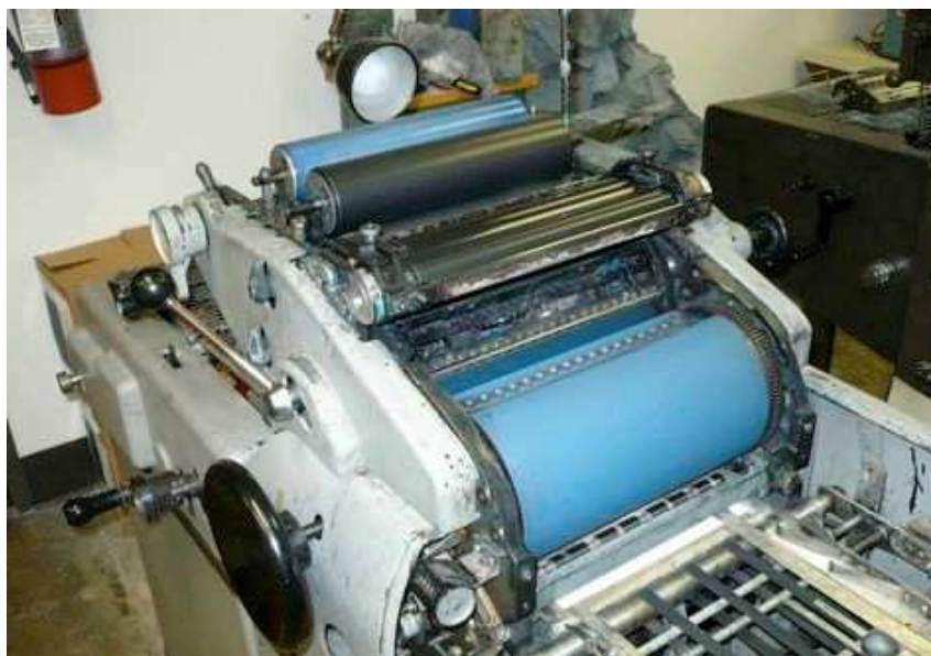
AM Multilith 1200, detail op rubberdoekcy-linder (blauw), direct daarachter half zichtbaar de plaatcylander met een reeks pennen waar de plaat mee ingeklemd wordt, erboven de inktrollen. Geheel rechts is een deel van de papierbaan zichtbaar: een snelle baan die vel voor vel het papier naar de rubberdoekcylander schiet.
