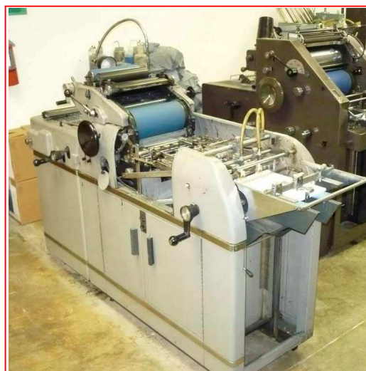
AM Multilith 1200, gezicht op voorkant, rechts op foto papierinvoer met pneumatisch grijpers, midden de cylinders en daarboven de inkt-(verf-)rollen, links de kettinguitleg.
